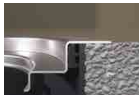
9. A bevonatszigetelés a rozsdamentes acél gallér éléhez záródjon hozzá, ahogyan a képen látszik!
