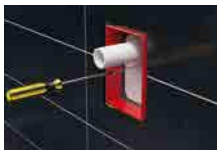
5. Helyezze az 1 csatlakozós szifonkazettát a lefolyótestbe és csavarja be a rögzítő csavart!
